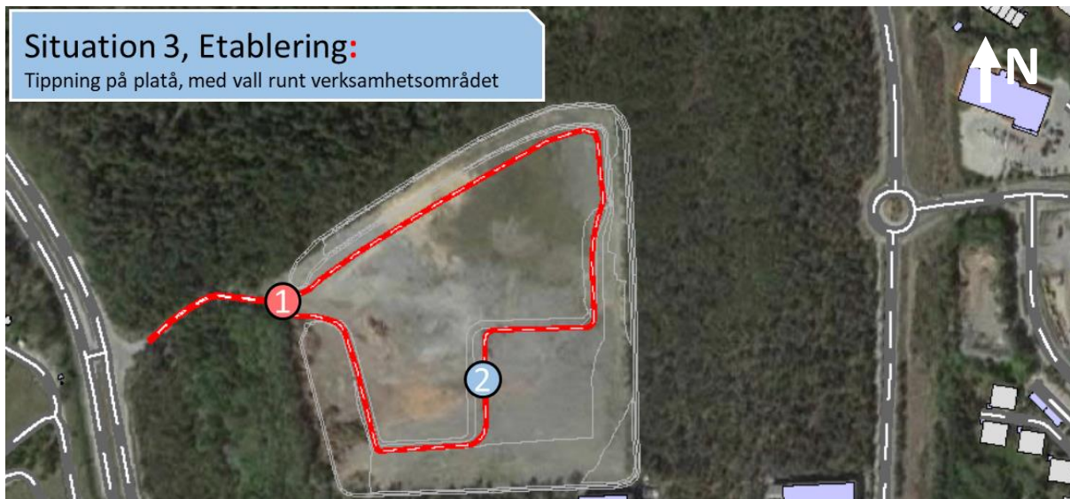
FIGUR 5. PRINCIPIELL SKISS FÖR ETABLERINGSSCENARIOT (3) DAGTID MED RÅBERGSVALLAR (10 M HÖGA) OCH TIPPNING PÅ RÅBERGSUPPLAG. TIPPNING SKER 5 M ÖVER BEFINTLIG, PLAN MARK.
