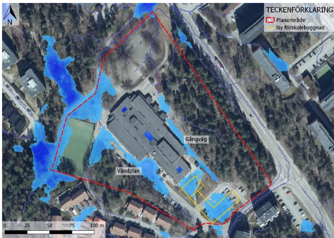
Figur 16. Lågpunktskartering från Scalgo, 0-1 m djup där mörkblå är djupast. De två lågpunkterna vid den planerade förskolebyggnaden omfattar ca 90 m 3 . En lågpunkt ses vid vändplanen och ett lågpunktsstråk ses längs med gångvägen nordost om den befintliga skolbyggnaden. Källa: Scalgo, 2022.
