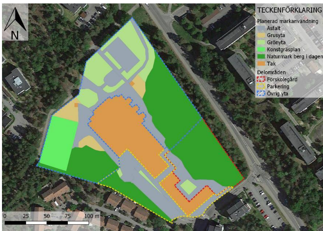
Figur 29. Delområden som används för att uppskatta magasinsbehovet och reningsgraden i de föreslagna dagvattenanläggningarna.
