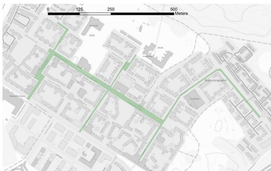
Figur 4. Grönmarkerat område visar enbart avrinningsområdet för åtgärden och inte åtgärderna då dessa utgör många små system som kan placeras längs med gatorna beroende på önskad utformning. Figur från DHI (2018).
