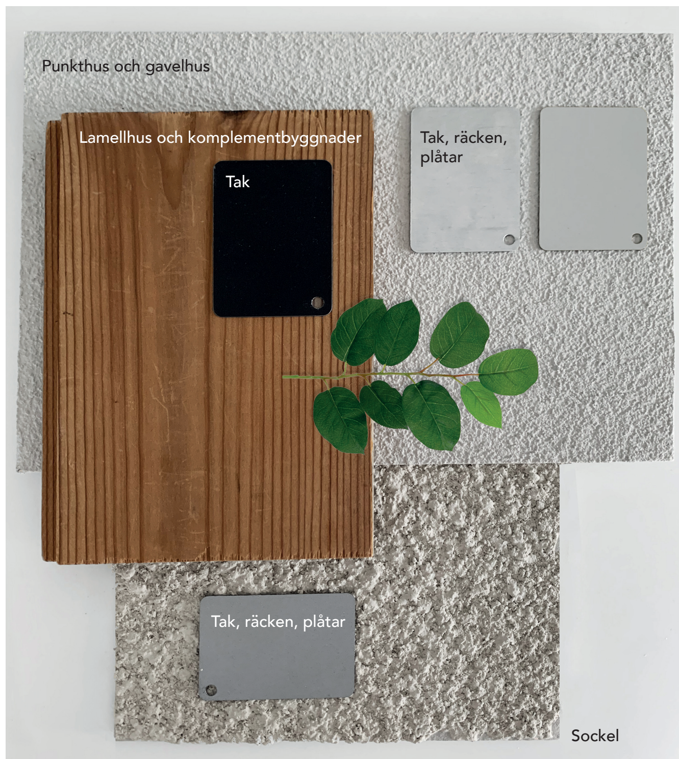
Putskulörer i varm ljusgrå. Träfasad i naturträ. Finkornig puts på fasader, grovkornig puts på sockel.
