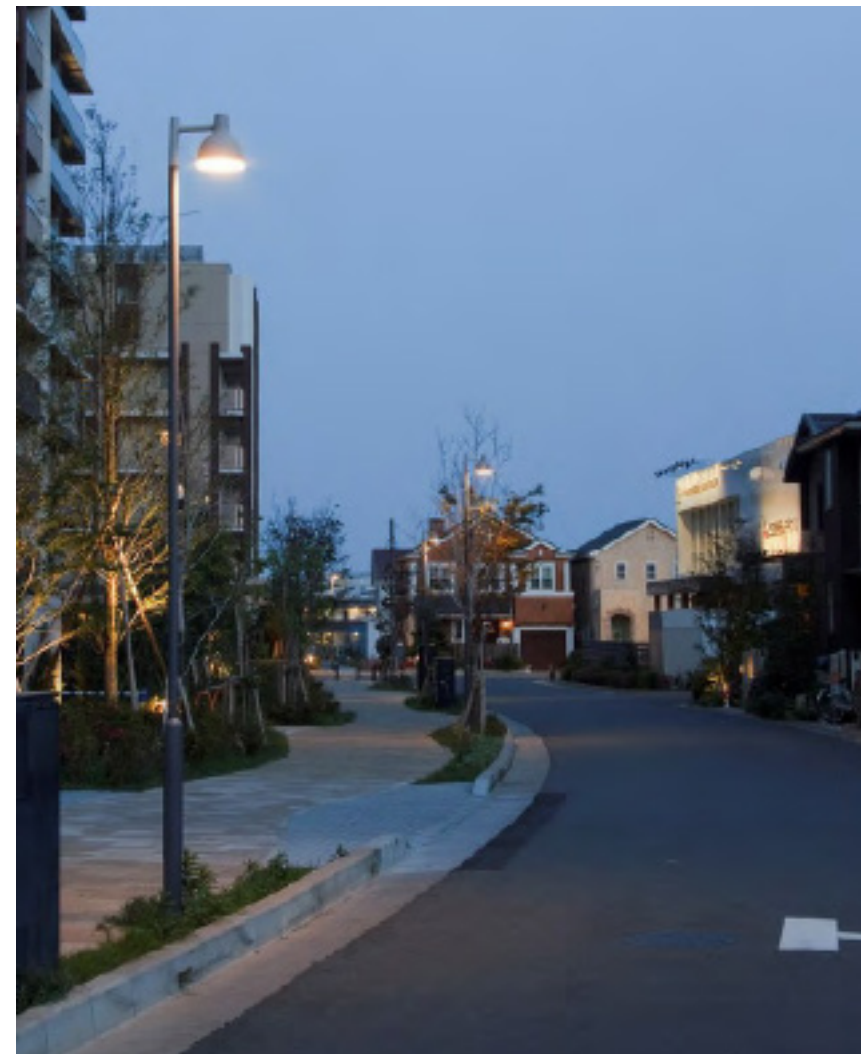
Exempel på armatur och stolphöjd som passar i gaturummets skala. Längs Bäverbäcken används dubbelarmad stolpe.
