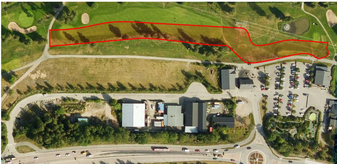
Ortofoto med område med risk för ras och skred markerat i rött.
