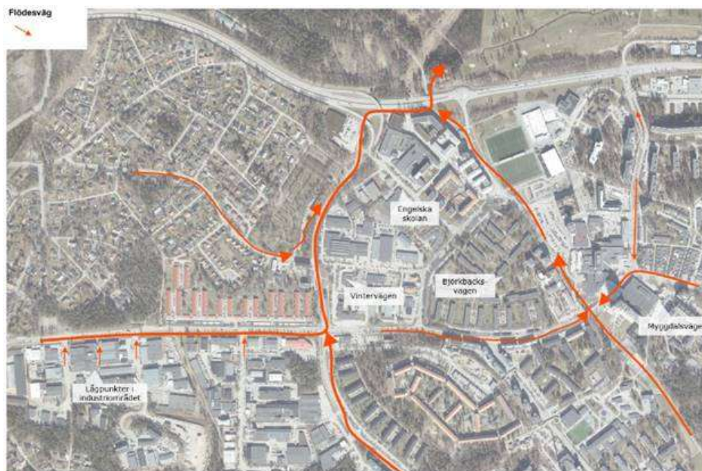
Flödesvägar vid skyfall, efter ombyggnation av gatorna
