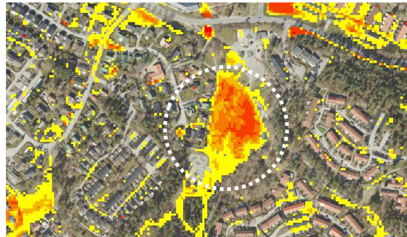
Figur 6. En stor lågpunkt som identifierats i stråkets östra delar, strax söder om Blomsterkungsvägen, tack vare stadens skyfallskartering.
