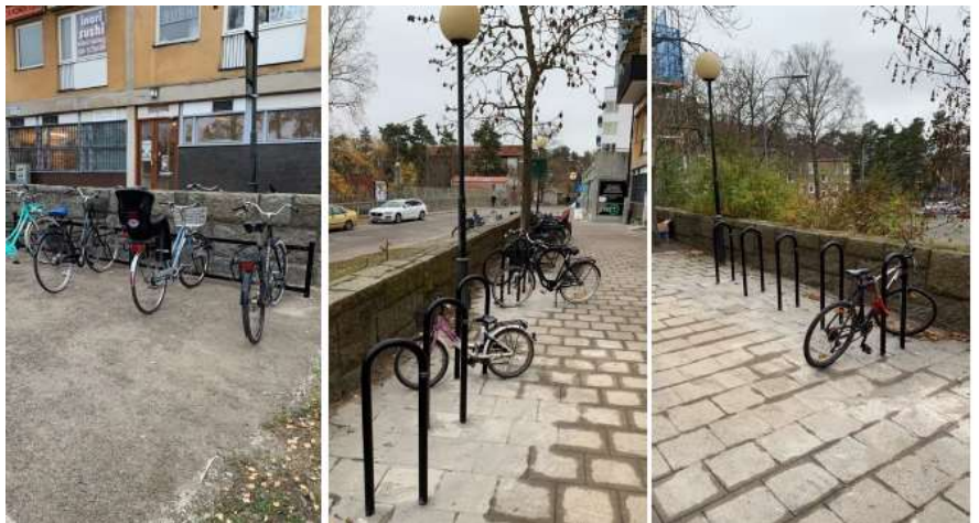
Figur 2. Vinjegatan. Framhjulshållare med ramlåsning och pollare "Bågen"
