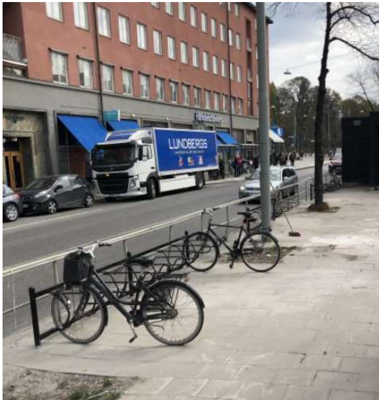
Figur 3. Valhallavägen 75. Framhjulshållare med ramlåsning
