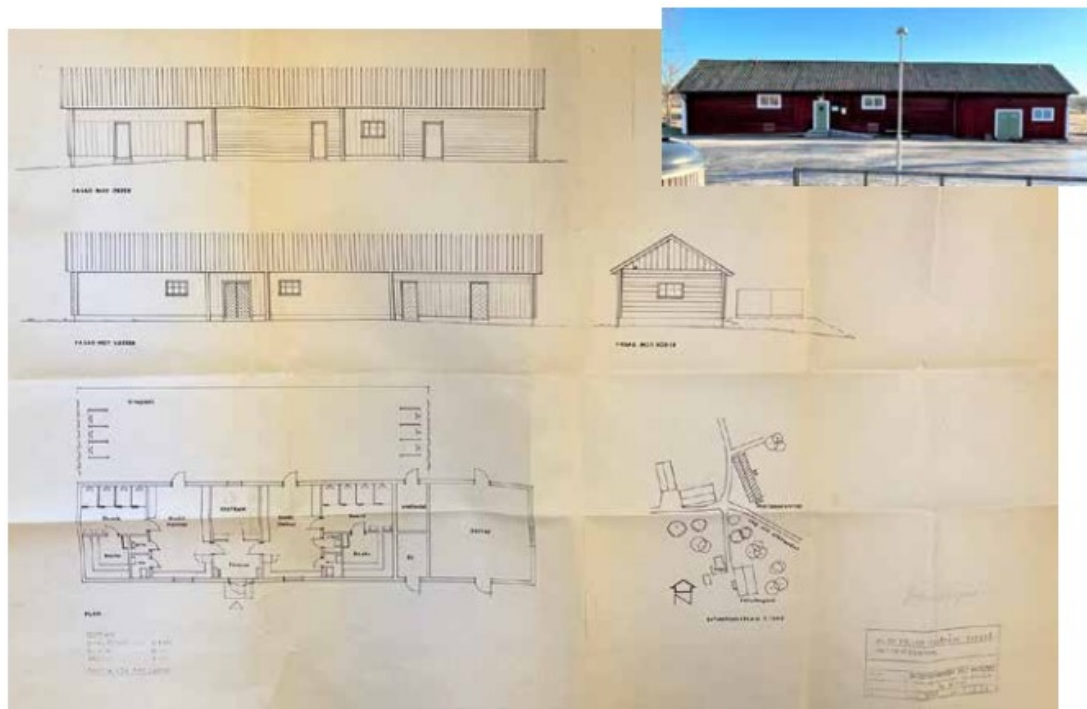
Ritning av Rolf Parmstad från 1969-10-01, Tyresö kommun. Fasaderna stämmer bättre överens med det äldre utseendet än det som blev resultatet av ombyggnaden, jfr den infällda bilden.
