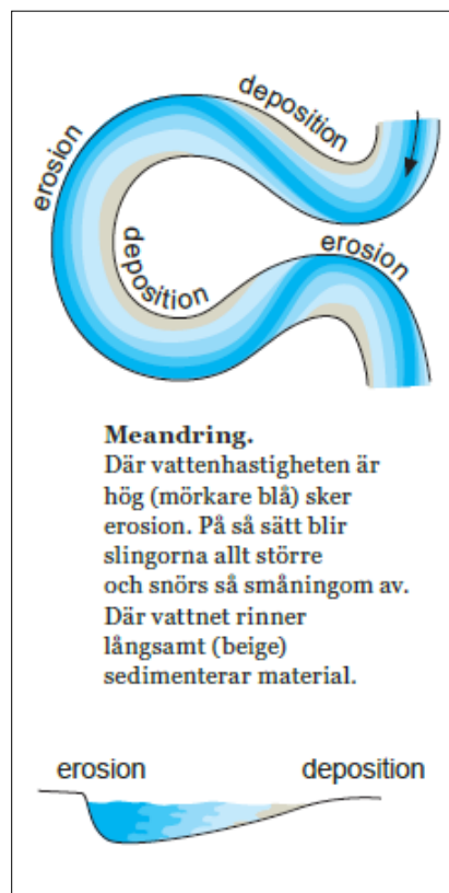
Figur 5. Principen för meandring. Bild tagen ur Ekologisk restaurering av vattendrag.
