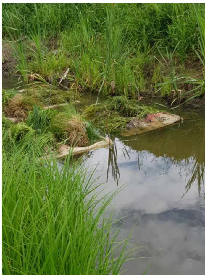
Figur 19. Växtflottar med starr provas i Igelbäcken för att se om de kan hjälpa till att ta upp PFAS ämnen ur vattnet.
