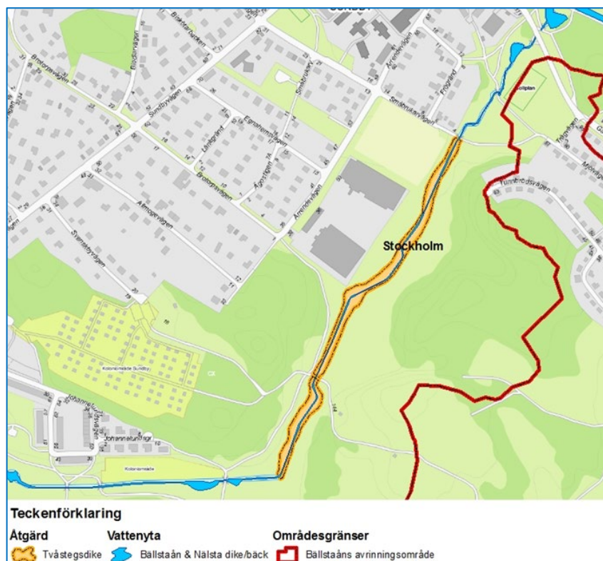
Figur 10. Föreslagen sträcka för tvåstegsdike i Nälsta dike/bäck
