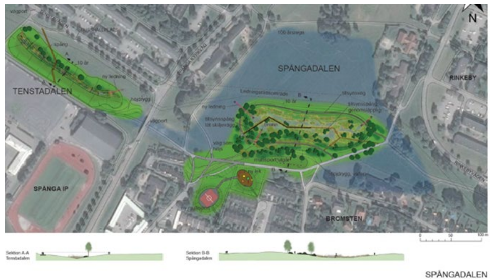
Figur 2. Illustration över dike och torrdammar i Spångadalen
