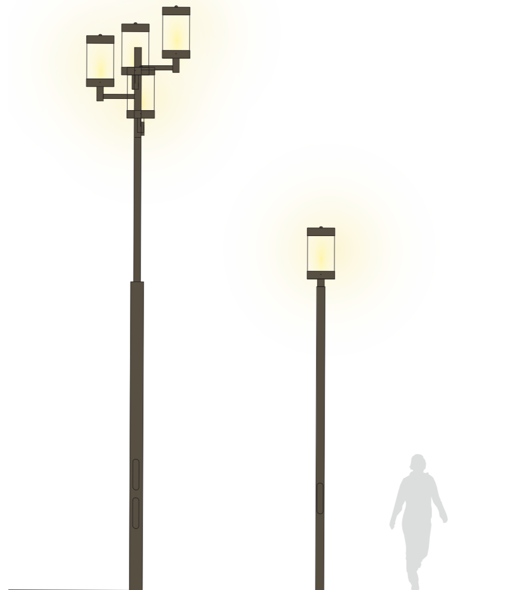
PRINCIPSEKTION TVÅ STOLPTYPEN, EN LÄGRE STOLPE MED EN TOPPMONTERAD LYKTA OCH EN HÖGRE STOLPE MED FYRA LYKTOR
