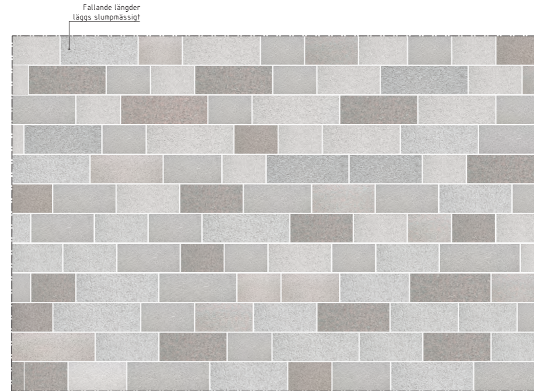
PROVYTA BELÄGGNING AV NATURSTEN N2 (STÖRRE INSLAG AV BEF. GRANITHÄLLAR)
