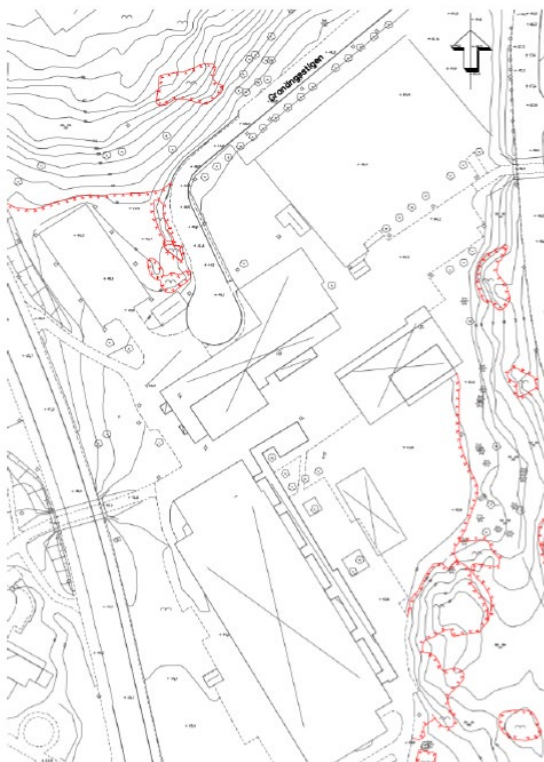
Figur 18. Inmätningar av partier med berg i dagen inom och i närheten av skolområdet.
