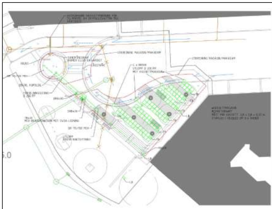
Figur 6. Bilden visar en principskiss eller ritning över den planerade skyfallslösningen. På ritningen är ytor som är tänkta att bli magasin för vattenfördröjning markerade. Runda cirklar visar var träd planeras. Ritningen visar också var ledningar är placerade och blå pilar visar hur vattnet rinner på ytan.
