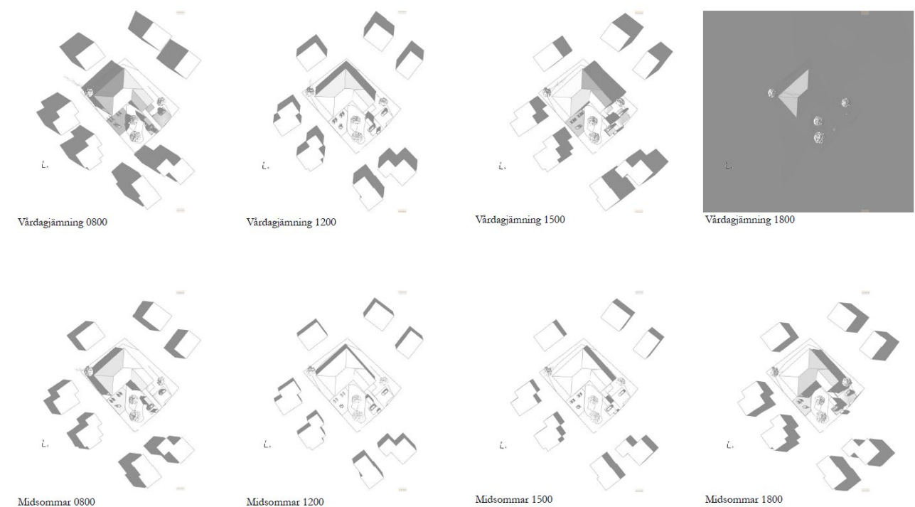
Figur 10. Sol- och skuggstudie för vår och sommar. Illustration framtagen av ZIN Arkitektur, daterad augusti år 2022
