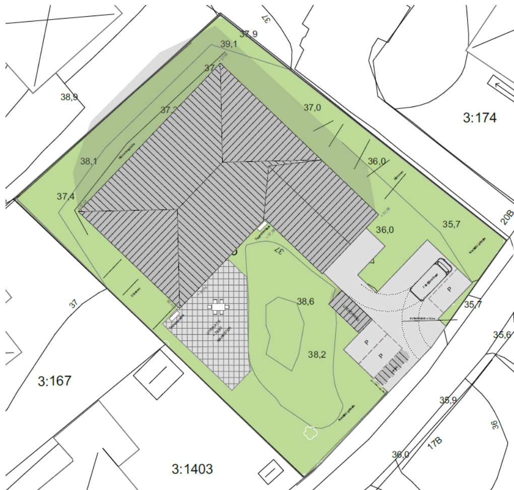
Figur 11. Illustration visar körspårsstudie över att en mindre buss (färdtjänst) inryms på fastigheten. Illustration framtagen av ZINK arkitektur, 2022
