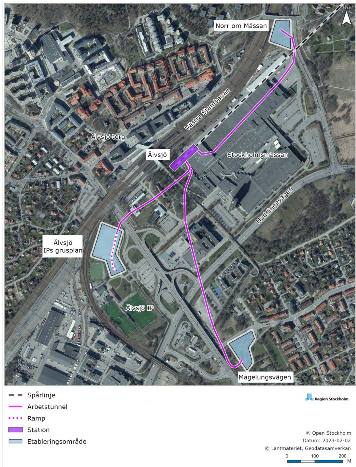
Figur 26. Studerade arbetstunnlar och tillhörande etableringsytor för station Älvsjö. Spårlinje och arbetstunnlarnas sträckning är ungefärliga.
