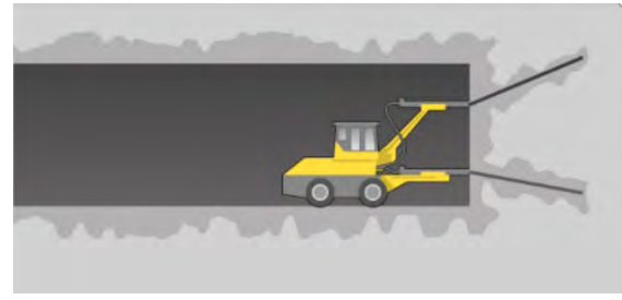
Steg 2: Injektering, betong sprutas in i borrhål och bergsprickor. När betongen stelnat bildas en tätning runt den blivande tunneln.
