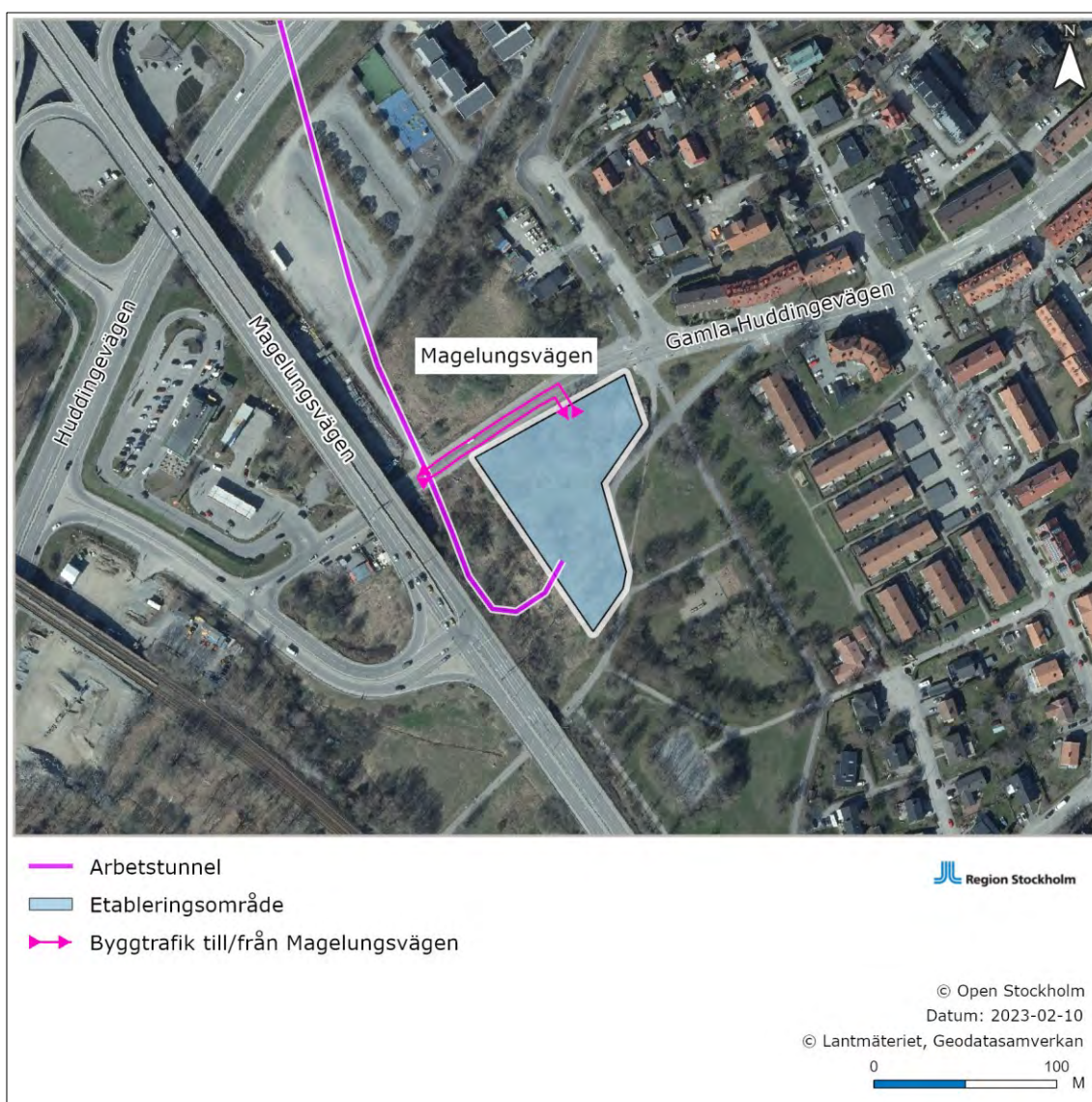
Figur 27. Etableringsyta för arbetstunnel vid Magelungsvägen samt möjliga transportvägar.
