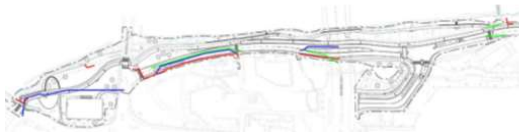
Figur 12 - Planerade större ledningsomläggningar
