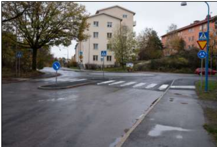
Bild 7: Cirkulationsplats med överkörningsbar rondell
