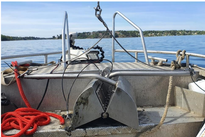
Figur 3. Bild på van Veen-huggare som användes vid provtagningen.
