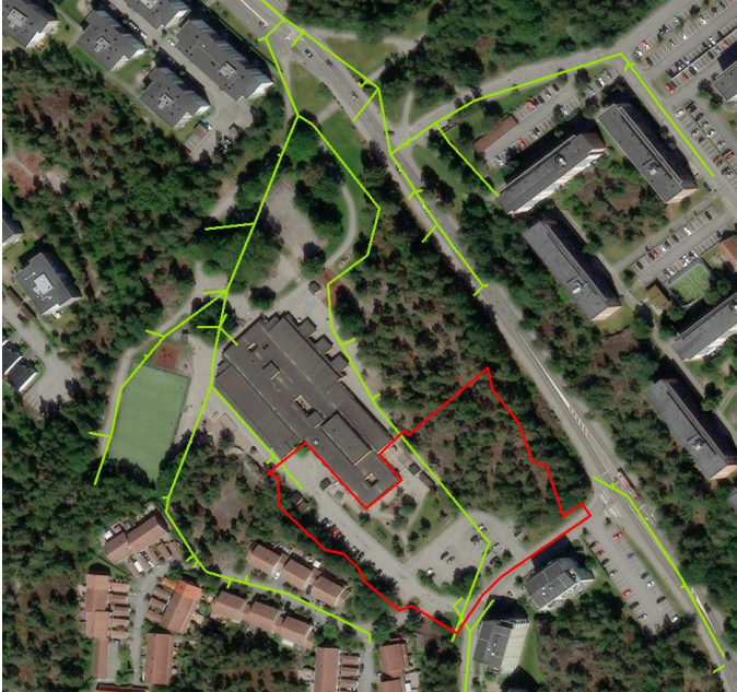
Figur 5: Befintliga dagvattenledningar (grönt) kring ungefärligt planområde (rött), bakgrundskarta © ArcGIS.
