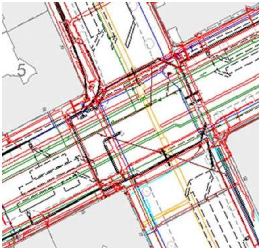
Figur 2. Exempel på ledningar och träd i en gatukorsning. Bilden illustrerar att det är trångt om utrymme för att anlägga växtbäddar och plantera träd på de flesta gångbanorna.
