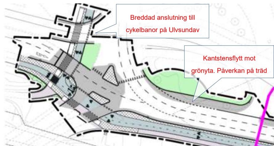
Figur 8. Planutsnitt över ny lösning vid Ulvsundaplan som visar på förskjutna körfält som ger plats för breddad gång- och cykelbana.
