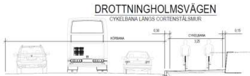
Figur 12. Sektion över ny cykelbana rakt fram förbi Alviksplan längs Drottningholmsvägen.
