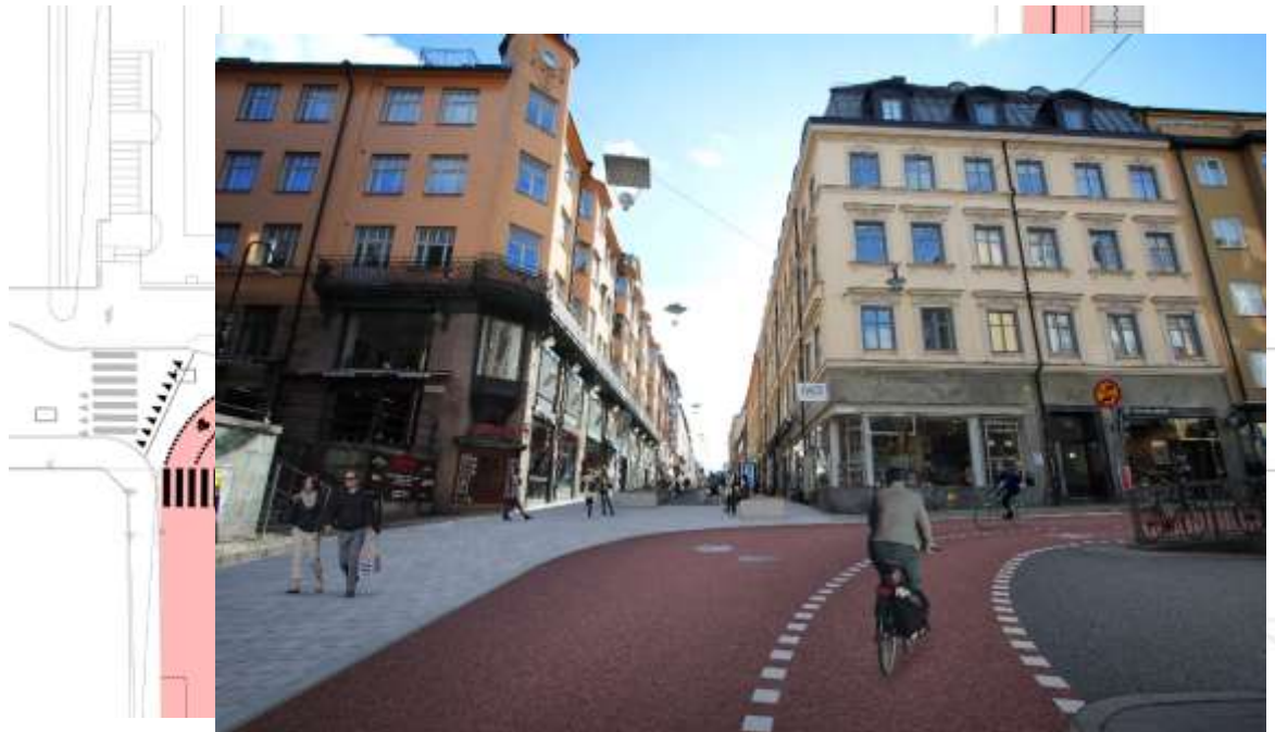
Bild 7. Illustration 1. Cykelbana och körbana med röd asfalt? Väjningsreglerad korsning. Bild 8. Fotomontage av korsningen Götgatan S:t Paulsgatan. Körbanans röda färg ger en visuell ledning längs hela den alternativa sträckningen. Gångbanan breddas till vänster i bild och en tydligare entré till gågatan skapas.
