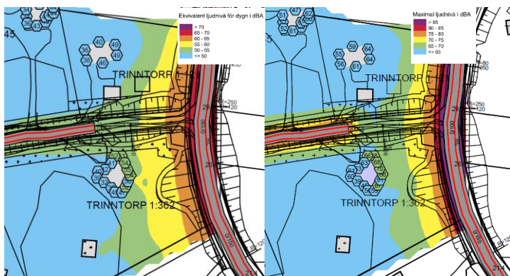
Figur 7. Fastigheter närmast Breviksvägen i öster. Vänstra bilden visar dygnsekivalent ljudnivå 1,5 m över mark och högsta nivå vid fasad vid 40 km/h. Röda trianglar markerar fastigheter där 55 dB(A) dygnsekivalent ljudnivå överskrids. Fastigheter som markeras med röd streckad linje klarar ej riktvärde för uteplats. Högra bilden visar maximal ljudnivå 1,5 m över mark (dag/kväll) och högsta nivå vid fasad (natt) vid 40 km/h. Röda trianglar markerar fastigheter där 70 dB(A) maximal ljudnivå överskrids.
