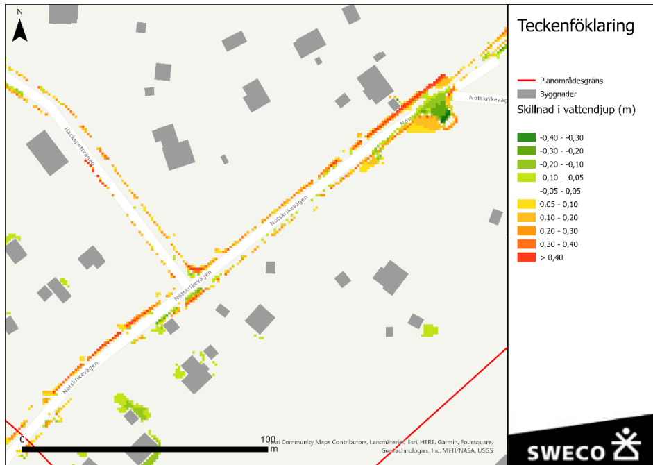
Figur 17. Jämförelse mellan nulägesituation och situation efter utbyggnad med åtgärdsförslag vid Nötskrievägen. I gröna områden medför detaljplanen mindre (vattendjupet minskar med 0,05 m eller mer) maximala vattendjup, i röda större (vattendjupet ökar med 0,05 eller mer).
