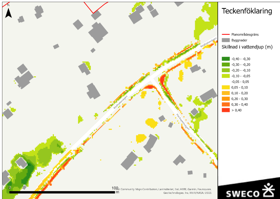
Figur 13. Jämförelse mellan nulägesituation och situation efter utbyggnad med åtgärdsförslag vid Hackspettvägen. I gröna områden medför detaljplanen mindre (vattendjupet minskar med 0,05 m eller mer) maximala vattendjup, i röda större (vattendjupet ökar med 0,05 m eller mer).
