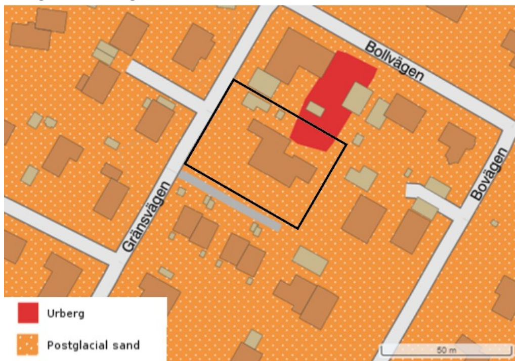
Figur 9. Bilden visar de översiktliga geotekniska förhållandena inom området.
