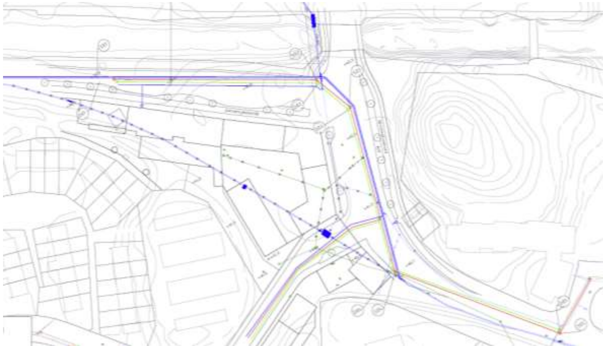
Figur 3. Förprojektering över ny- och omförläggningar för alternativ 1. Den blå linjen visar ny sträckning för huvudvattenledning. Parallellt med denna förläggs spill- (röd) och dagvattenledningar i Magelungsvägen. Befintliga ledningar inom den blivande kvartersmarken slopas.
