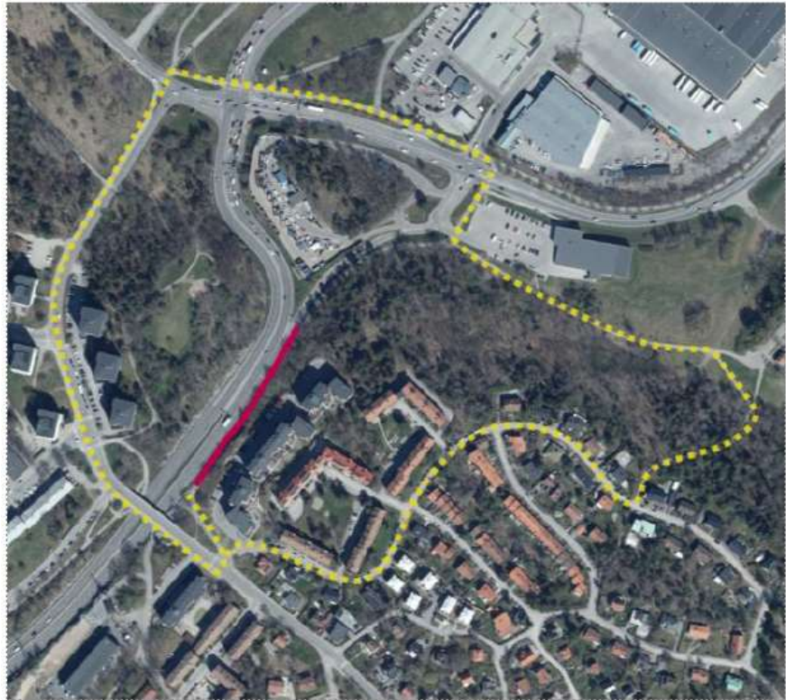
Figur 14, exempel på omledning för gång- och cykeltrafik under byggtid, delsträcka 3 och 4 i rött.
