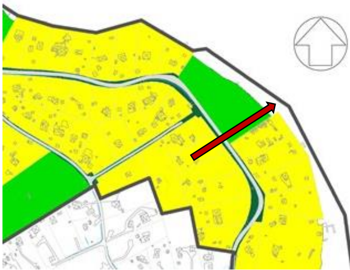
Figur 4-4. Illustration på riktning av avledning med hjälp av styrd borring, för dagvatten i Entitevägen ut mot Breviksvägen.
