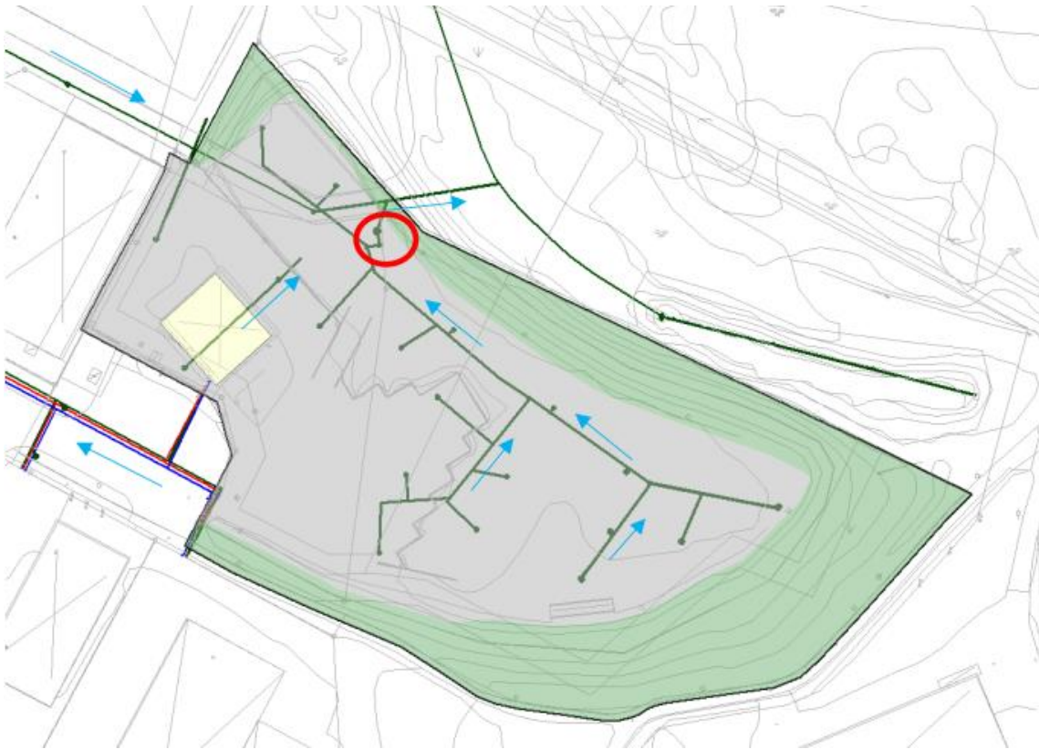
Figur 12. Ledningsnät inom och utanför kretsloppscentralen. Befintlig oljeavskiljare har markerats med röd cirkel. Antagna flödesriktningar är markerade med blå pilar (Bjerkling, 2024-04-09)
