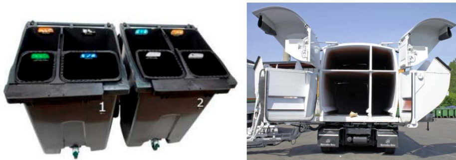
Figur 3 Fyrfackskärl (vänster) och fyrfacksfordon (höger). Bildkälla: (Andersson, Sundqvist, Hultén, & Sandkvist, 2018).
