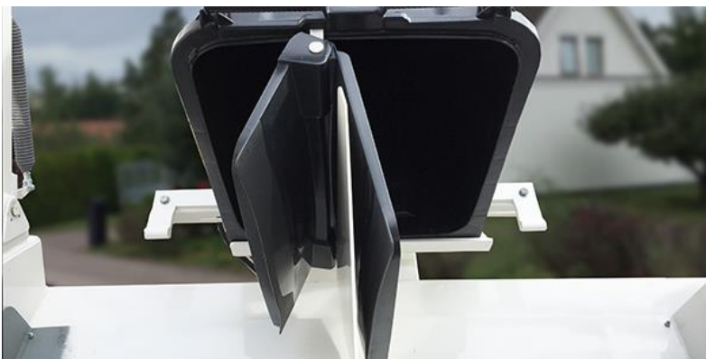
Figur 5. Tvåfackskärl töms i sidlastande fordon utrustad med "hajfena", foto San Sac.
