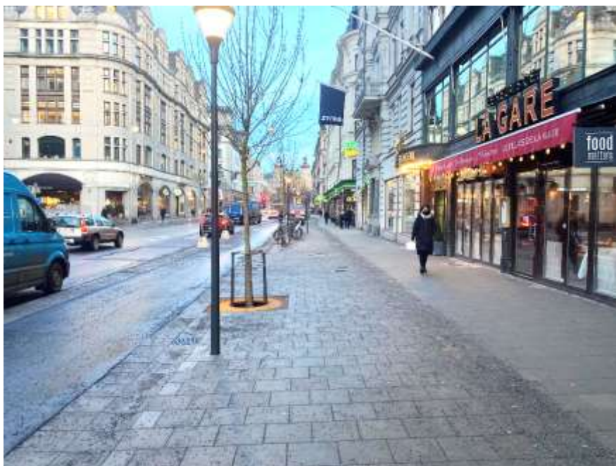
Figur 11. Fotografi taget i januari 2022, efter ombyggnad. Vasagatan i norrgående riktning mot Gamla Brogatan. Nya träd har planterats, vistelseytorna är bredare och den nyanlagda cykelbanan är separerad från övrig trafik.
