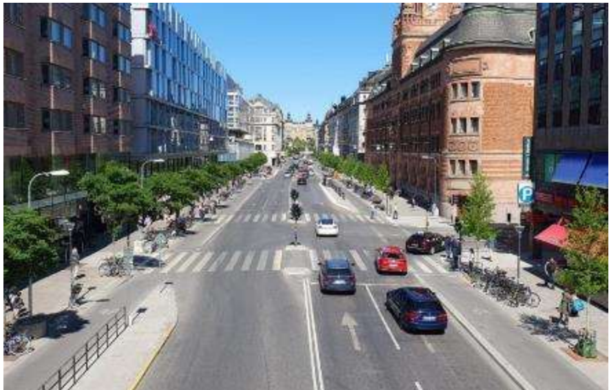
Figur 7. Fotografi taget i juni 2023, efter ombyggnad av gatan. Vy från Klarabergsviadukten i riktning norrut. Bilden visar det omdisponerade gatuutrymmet med nyplanterade träd, bredare gångbanor och separerade cykelbanor.
