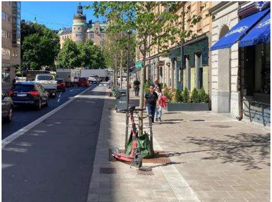
Figur 17. Fotografi taget i juni 2022, efter ombyggnad. Vasagatan i riktning norrut mot Norra Bantorget. Cykelbanan har flyttats ut mot körbanan, nya träd har planterats, gång och vistelsezoner har breddats.
