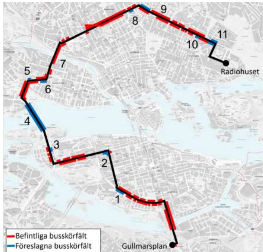
Figur 4. Översiktsskarta med åtgärdsförslag för stomlinje 4. På rödmarkerade sträckor finns idag befintliga busskörfält. På blåmarkerade sträckor föreslås nya busskörfält.
