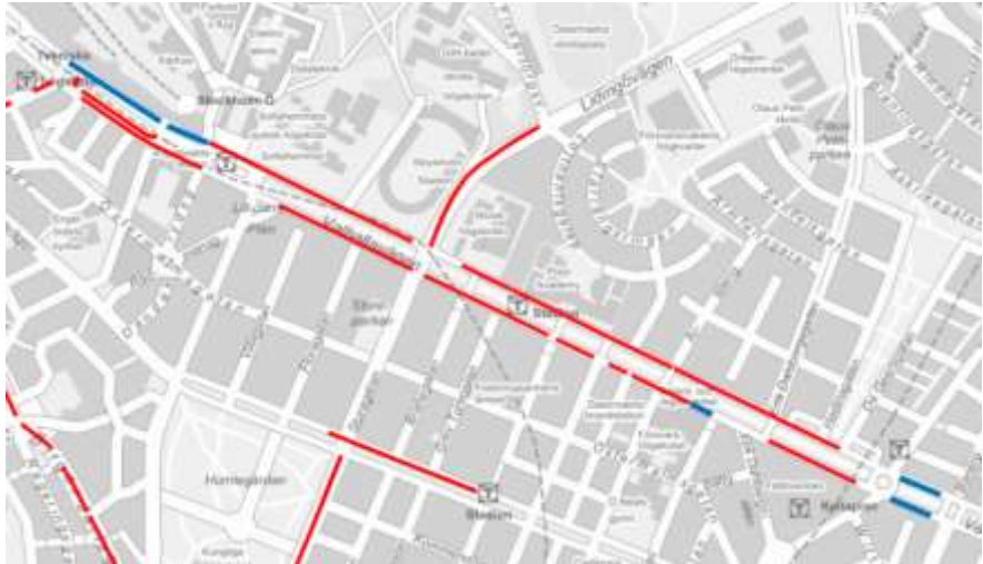
Figur 18, Översiktskarta som visar befintliga busskörfält på Valhallavägen i rött och nya föreslagna busskörfält i blått.
