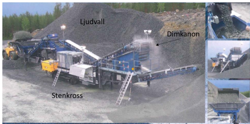
Bild 13, exempelbild på en stenbrytare med förslag på ljud- och dammdämpande åtgärder.
