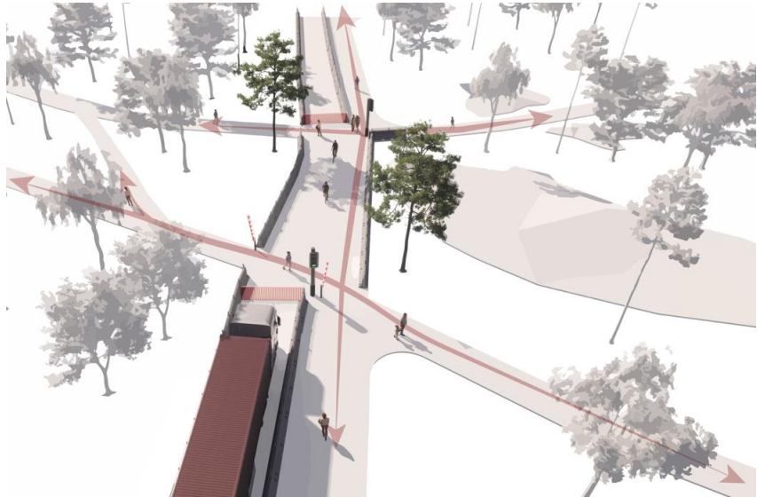
Bild 9, Slussen norr om Bergholmstorpet som visar öppen passage för gång- och cykeltrafik och stängd väg för byggtrafiken.
