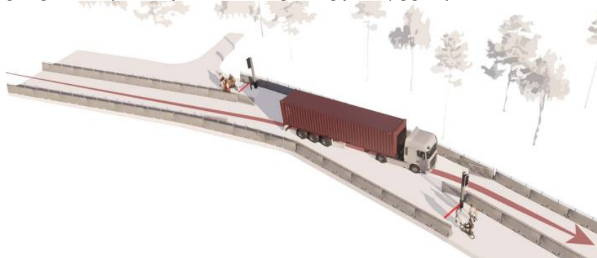
Bild 7, Skarpnäcksvägens sluss som visar öppen passage för byggtrafiken och stängd väg för gång- och cykeltrafik
