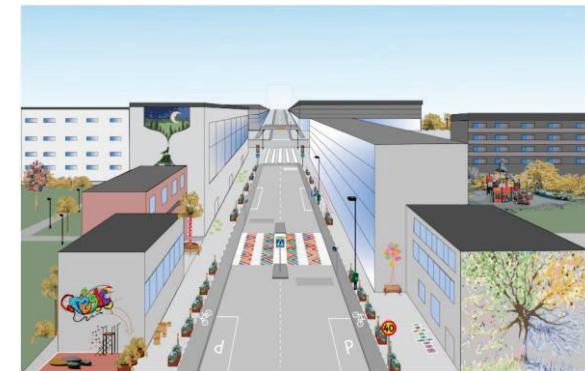
Figur 3. Illustration av ett urbant gaturum där åtgärder enligt barnets perspektiv har gjorts för att öka barnvänligheten. Detta syns genom färgglada inslag i gaturummet, välmarkerat övergångsställe, blomsterlådor som separerar cykeltrafiken från fotgängarna. Grönska, samt lekfulla inslag där det är säkert. I Carlsson & Lemheden, 2022.
