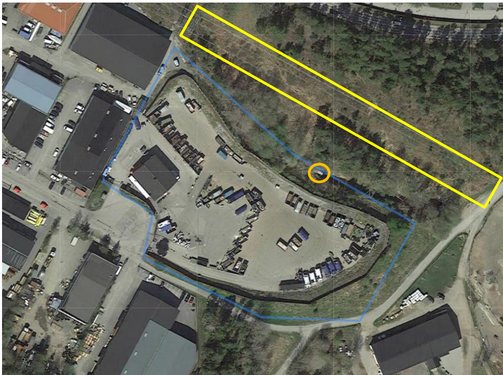
Figur 2. Satellitfoto över området där blå linje visar ungefärligt utredningsområde. Kraftledningarna markeras med gul linje och utloppspunktern för diket markeras med orange cirkel (Lantmäteriet, 2023).
