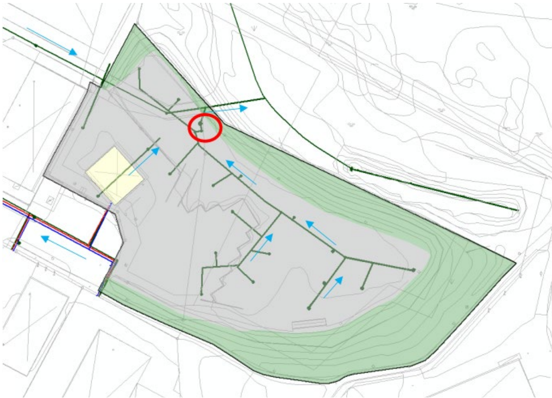
Figur 12. Ledningsnät inom och utanför kretsloppscentralen. Befintlig oljeavskiljare har markerats med röd cirkel. Antagna flödesriktningar är markerade med blå pilar (Björking, 2024-04-09)
