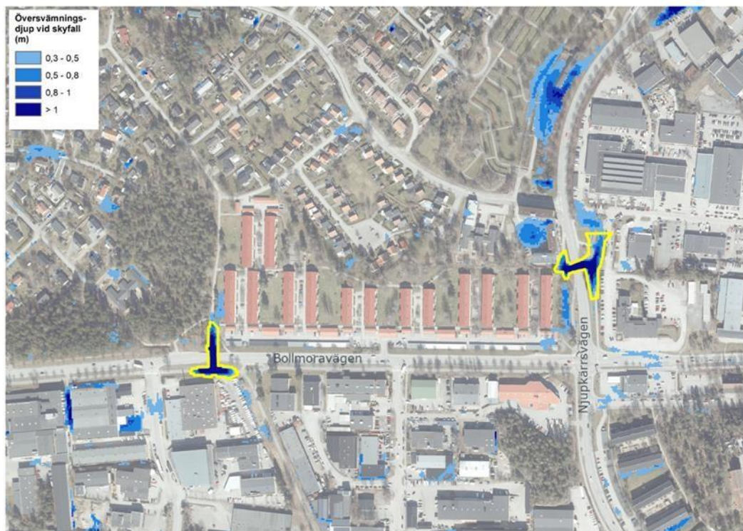
Figur 8. Maximalt översvämningsdjup vid 100-årsregn med klimatfaktor. Gång- och cykeltunnlarna samt ytan där skyfallsvatten magasineras är markerade med gult.
