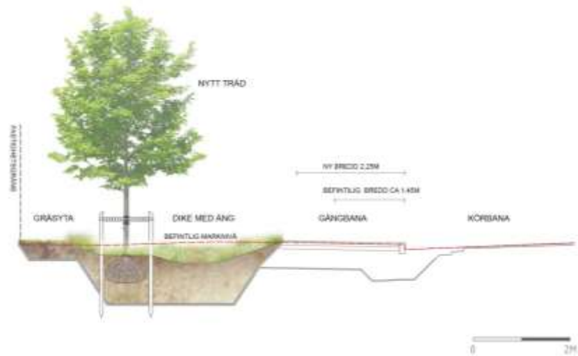
Bild 7. Illustrativ sektion av principlösning längs sydvästra sidan av Årdalavägen, som visar den nedsänkta ängsgräsytan med planerat träd dit dagvatten från gatan kan ledas för fördröjning, ytligt och i växtbädden. Illustration: Sweco Sverige AB
