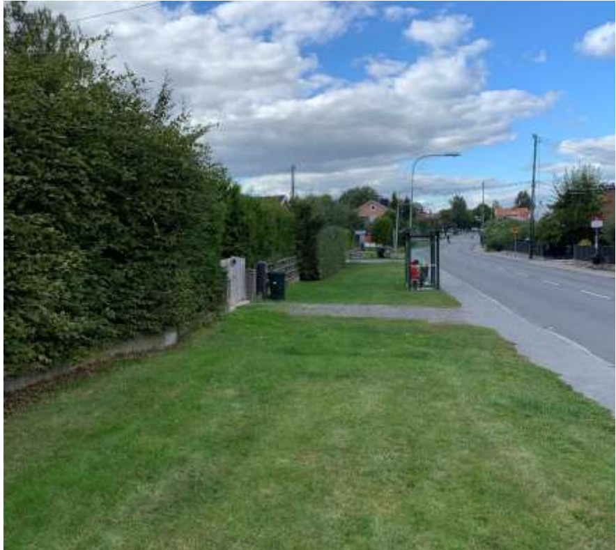
Bild 6. De klippta gräsytor på gatemark längs en del av Årdalavägen är föreslagna att sänkas för att fördröja dagvatten. Foto: Funkia AB
