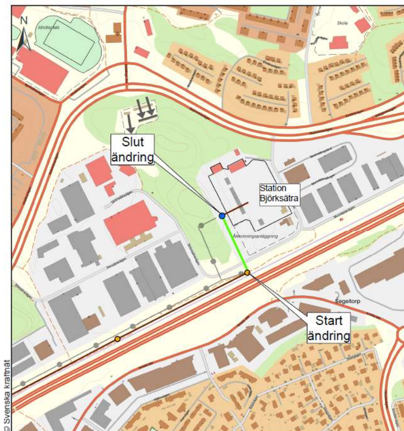
Figur 2: Grönmarkering visar den tillfälliga ledningssträckningen som koncessionsändring avser. Blåmarkering visar ungefärlig placering av tillfällig stolpe inom Ellevios tomrätt.
