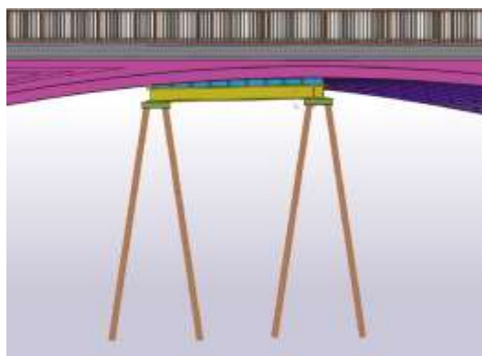
Bild 3: Vy av förstärkning av ett bågspann på Vasabron.
