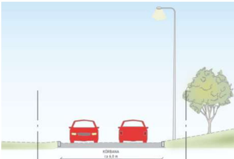
Figur 3. Befintlig gatusektion för Helsingörsgatan.
