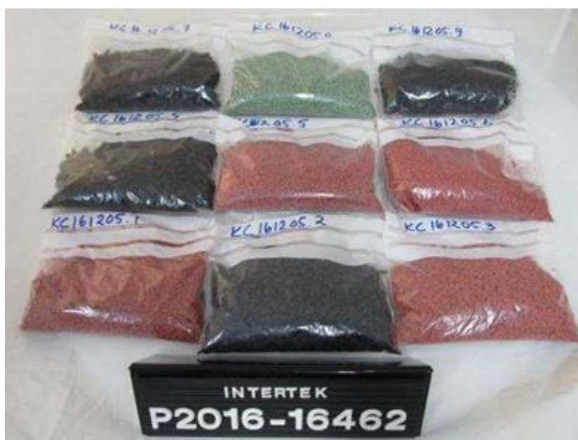
Figur 1 - Analyserade prover av SBR och EPDM gummigranulat 2016.
