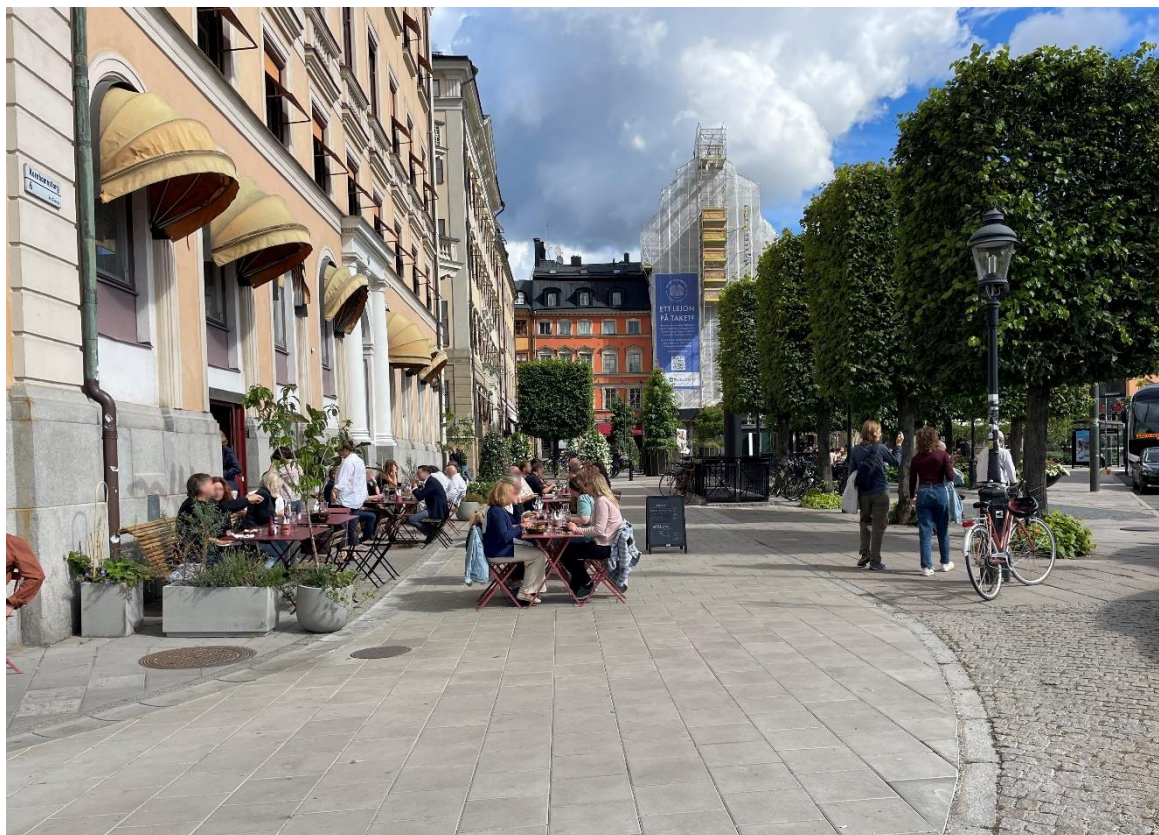
Figur 9. På Kornhamnstorg har lokalgatan höjts upp till gångbanans nivå och därmed har gångytorna vuxit och givit mer plats för vistelse.
