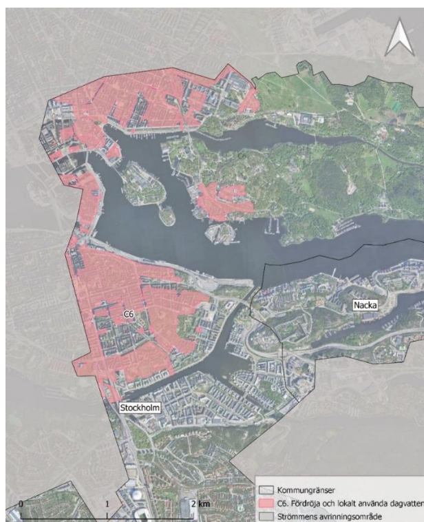
Figur 27. För att avlasta det kombinerade ledningsnätet och minska risken för bräddningar kan åtgärder utföras inom område markerat i rosa.
