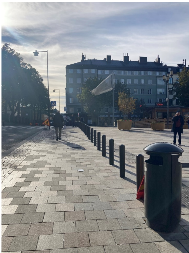
Bild 18. Fotografiet visar hur gångbanan och del av torget ser efter upprustningen. Nya ljusa granithällar. Pollarrad som hindrar fordon att köra in på torget. Konstverket Vindspår och blomsterurnor i bakgrunden.
