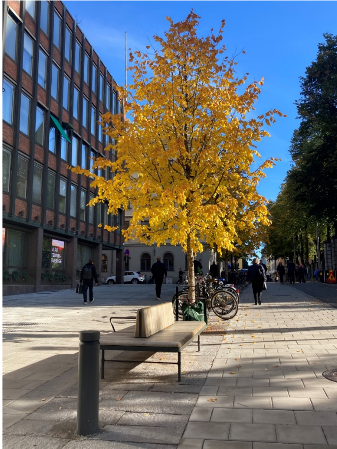
Bild 5. Detaljfotografi på Storgatan som visar pollarbelysningen, soffan, de nyplanterade träden och cykelställen. Dessa är placerade i möbleringszonen vars markbeläggning består av återanvända granithällar som tidigare låg på torget.
