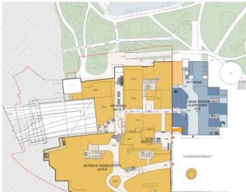
Bild 4: Planområdet avgränsas med röd linje. Befintlig och ny bebyggelse för handel och kontor med mera i gult. Ytor för befintlig samt tillkommande tunnelbana i DP tunnelbana Älvsjö-Fridhemsplan (Dnr: 2020-09494) i blått.
