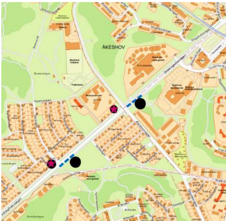
Bild 3. Karta som visar projektets utbredning längs Drottningholmsvägen mellan Brommaplan och Rånövägen. Streckad linje visar sträckor där busshållplatser har anlagts. Hållplatser är markerade som punkter. Punkter med stjärnor markerar hållplatser som har utgått.
