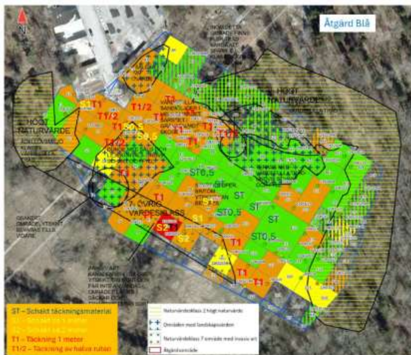
Figur 4: Åtgärdsplan för Södra Snösätra. Rutnätet visar ytor som behöver åtgärdas och bokstavsbezeichnungarna anger föreslagen metod: T = täckning, S = schaktning och ST = schaktning av renare massor som återanvänds som täckningsmaterial.
