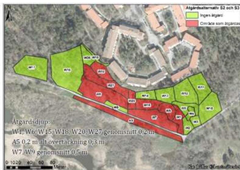
Figur 2: Stora skjutbanan, röda delområden är indelade utifrån blyhalt och genomförande i förhållande till bedömd djup till berg.
