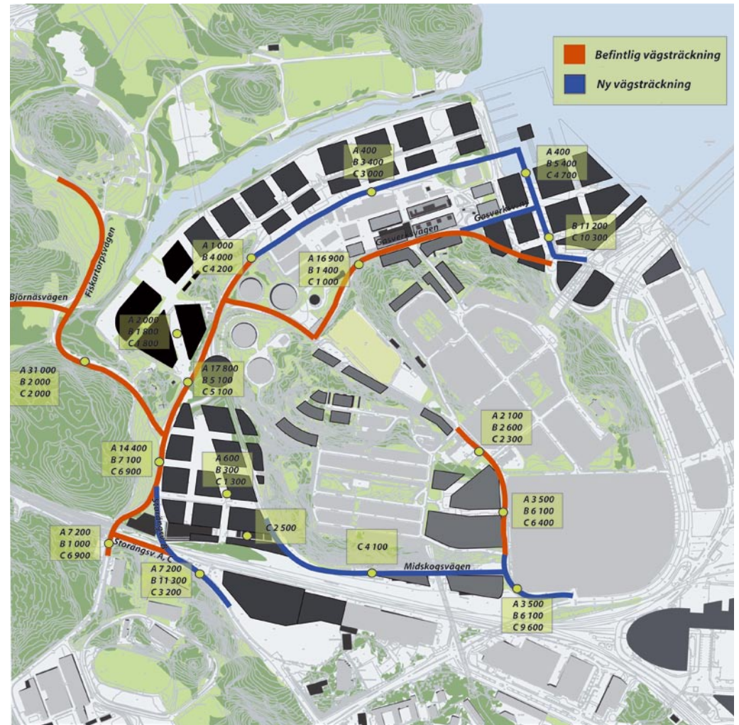
Figur 4.4.4 Alternativa vägsträckningar samt beräknade trafikflöden
